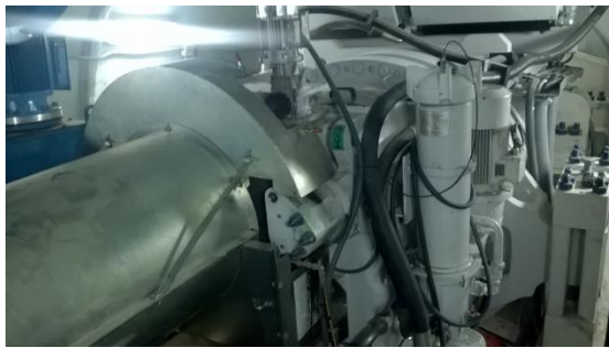
Tren de potencia, sin bloquear en condiciones de operación. Non-blocked drive shaft under operation conditions.
