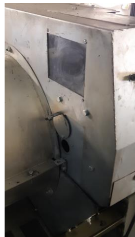
Pinza de freno con el orificio donde se introduce el bulón de bloqueo. Brake clip with the hole into which the blocking bolt is inserted
