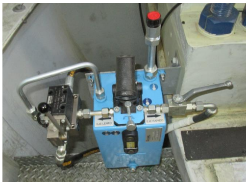
Bomba manual para extracción del pistón, en la posición inicial. Manual pump for extracting the piston, in the initial position.
