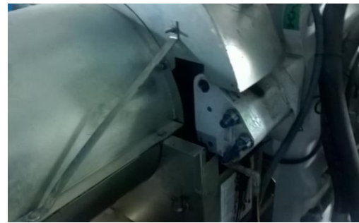
Pinza de freno con el orificio donde se introduce el bulón de bloqueo. Brake clip with the hole into which the blocking bolt is inserted
